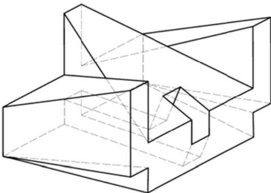
**Ejercicio 2:** Se da la perspectiva de una pieza mecánica. Realizar el número mínimo de vistas necesarias para definirla seleccionando el alzado más conveniente. No se establece escala de trabajo y se podrá operar a mano alzada o, si se desea, con instrumentos. Cuidese la proporción y correspondencia.
